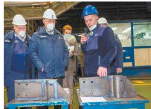
Начальник цеха штамповки и сварки деталей кабин ПРЗ Ярослав Василенко показал приспособления Poka-yoke: они не допустят изготовления брака
