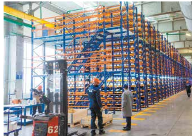
Раньше мелкие запчасти хранились по всему корпусу АЗК, а теперь вся мелочёвка собрана в едином участке — получился такой современный мезонин на 20 тысяч ячеек
