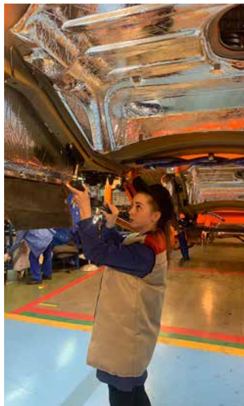
Контролёр станочных и слесарных работ 2 класса ОТК автосборочного производства Валерия Шелехова проверяет степень затяжки болтов
