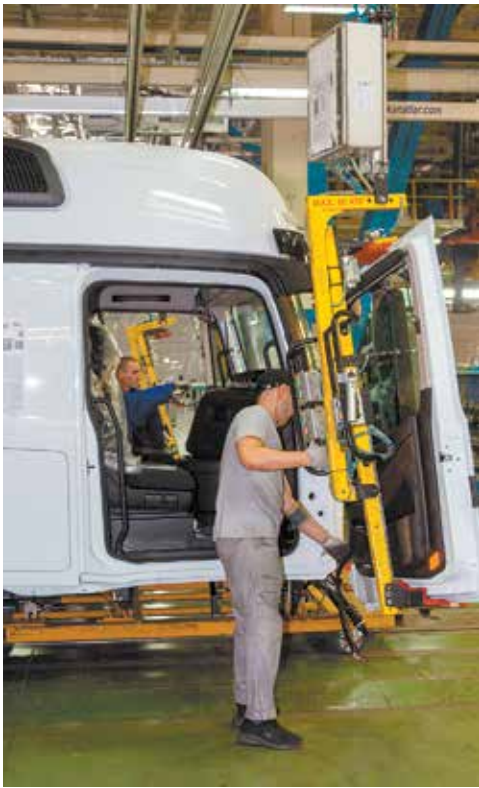
Установка дверей с помощью манипулятора занимает пару минут
