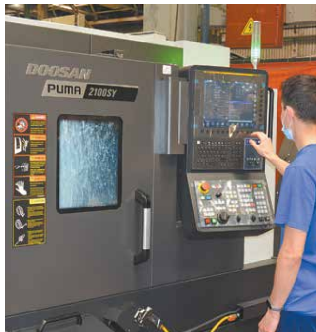
Высокопроизводительный горизонтальный токарный центр Puma — одна из технологических новинок
