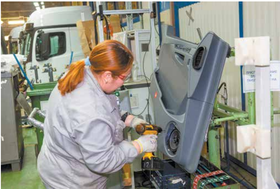
Собирать двери на специально оборудованном рабочем месте гораздо удобнее, чем на весу
