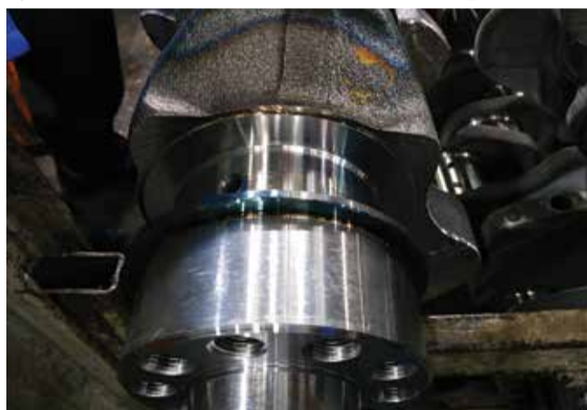
Так выглядит безупречно отполированный на линии Nagel коленвал
