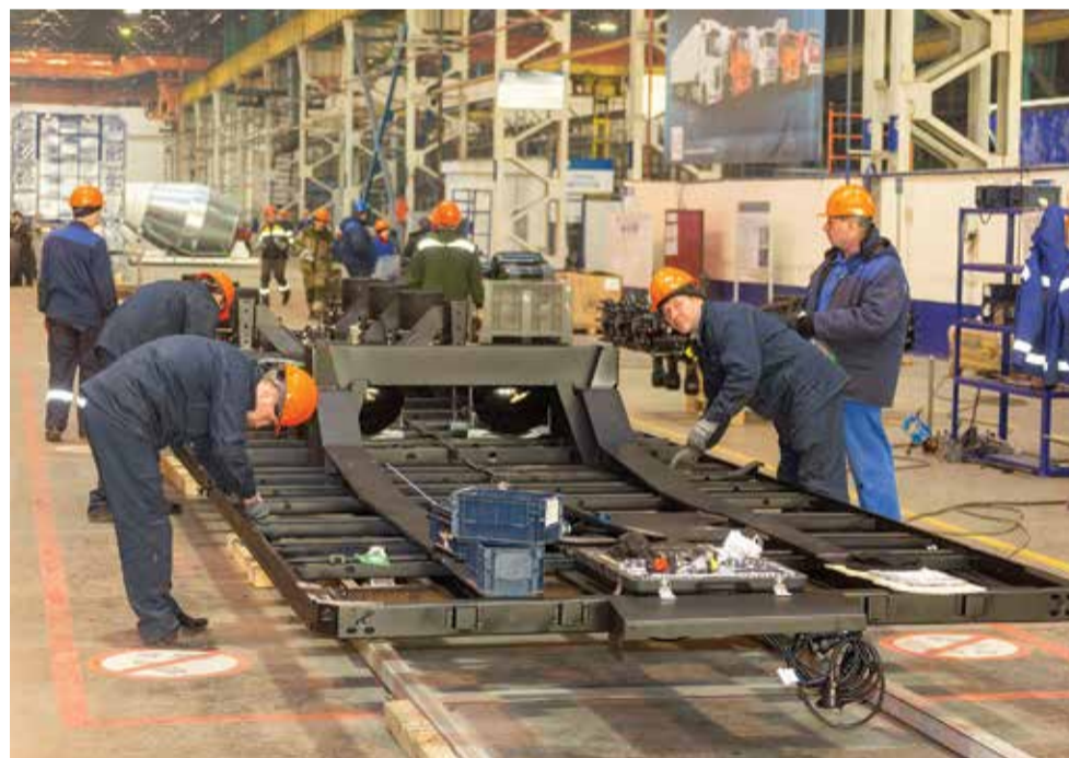
Рабочие ТЗА заняты на сборке рамы полуприцепа
