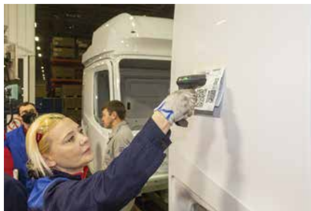
Контроль MES включается сразу после регистрации комплектующей ведомости кабины
