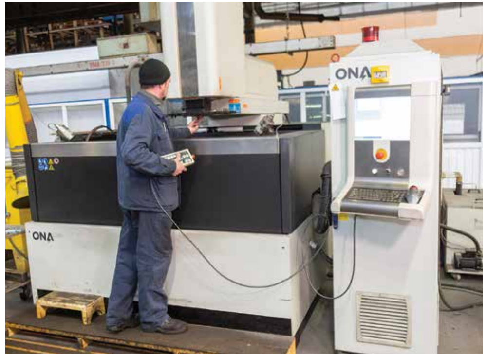
Один высокотехнологичный электроэрозионный копировально-прошивочный станок ONA заменил целую группу электроэрозионных станков старого поколения
