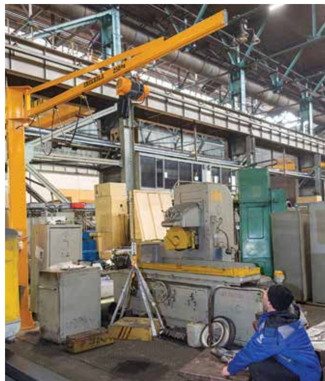
Кран прошёл испытания. Теперь вместо условного груза он будет переносить тяжёлую штамповую оснастку на обрабатывающий станок
