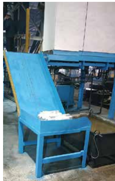
Отливки опускаются в ванну с помощью склиза
