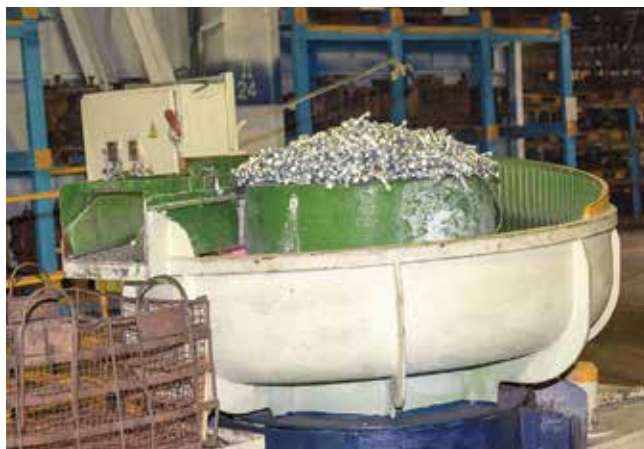
Здесь цинковые отливки проходят очистку
