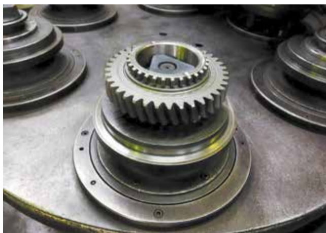
Универсальный переходник, предложенный Файлем Рахматуллиным, позволяет обрабатывать семь видов деталей без перемещений тяжёлой оснастки
