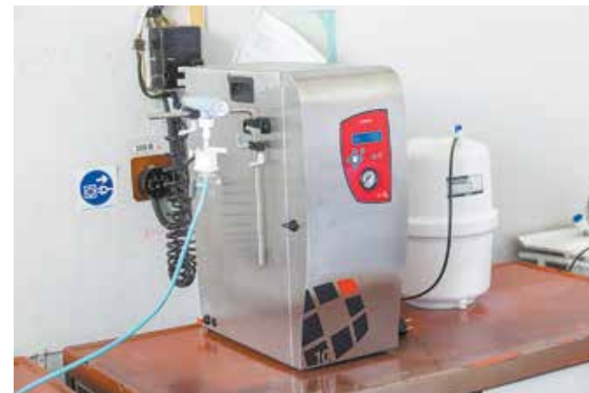
Мощности этого деминерализатора хватает, чтобы обеспечить лабораторию чистой водой. На производстве у установок другие масштабы
