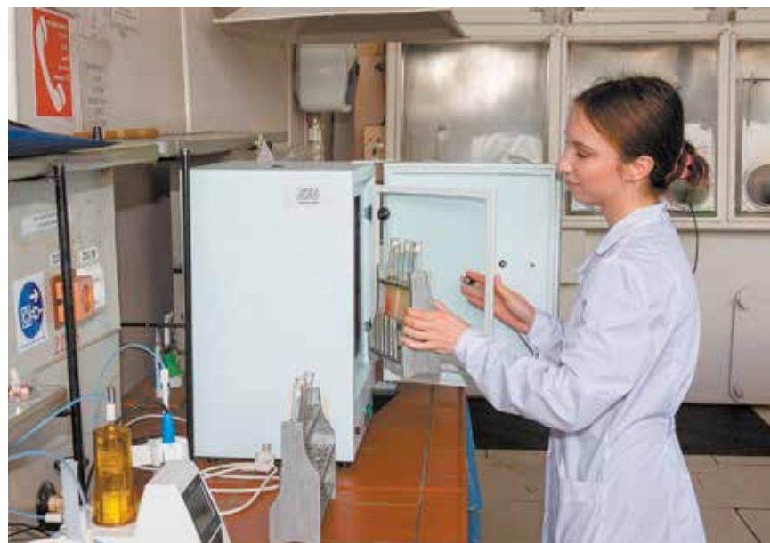
В пробирках — образцы поражённой бактериями водной СОЖ после пребывания в суховоздушном термостате в течение 24 часов
