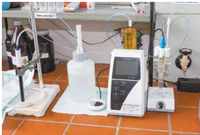
Потенциометрический титратор определяет содержание компонентов в водном растворе. Раньше это делалось вручную
