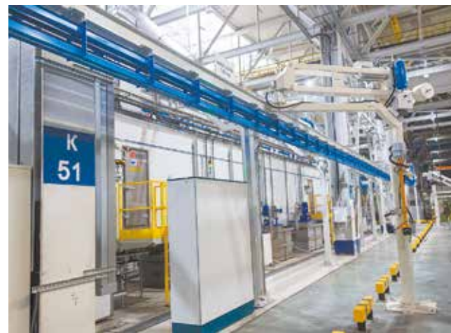
Крупногабаритные детали будут завешиваться и сниматься с ПТК с помощью манипуляторов
