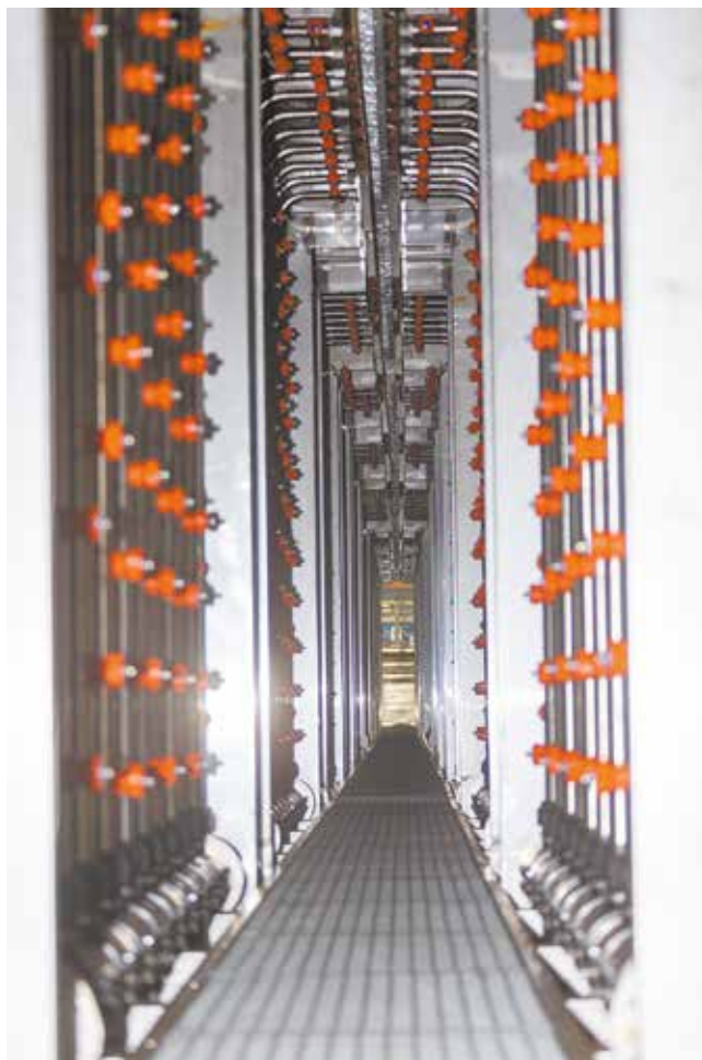
Сотни струй агрегата химической подготовки поверхности чистят детали перед нанесением грунта
