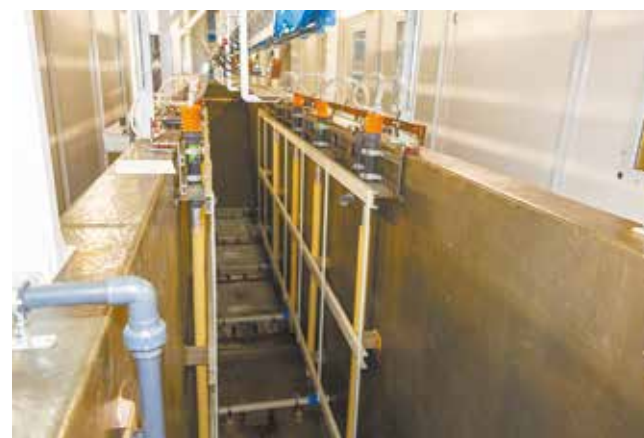
В этой ванне будет идти катафорезное грунтование
