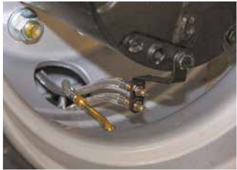
Для установки гибкого удлинителя вентилей была предусмотрена вот такая сложная конструкция
