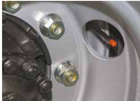
Пластиковый удлинитель просто навинчивается на вентиль
