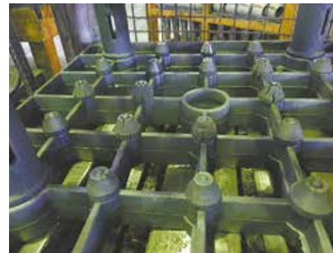
Жёсткая фиксация не даст смещаться деталям в оснастке. Над этим поработала Лилия Белоглазова
