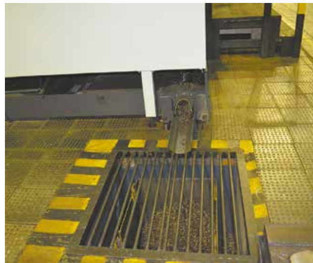
Так организован сбор стружки на станке с ЧПУ ВМ-2100 по предложению Ильдара Хуснутдинова
