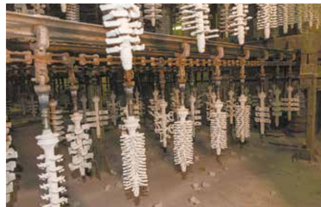
Чтобы сушка керамических форм шла качественно, в камере должна поддерживаться температура 23-26 градусов и влажность в диапазоне 45-50%
