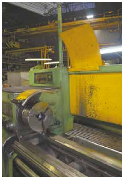
От стружки и брызг СОЖ станочника защитит металлический кожух — это кайдзен-предложение внёс Артур Трушников
