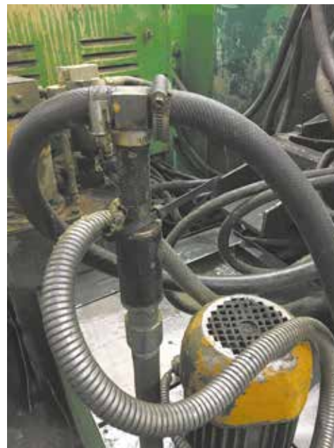
С механическими обратными клапанами, управляемыми гидравлическим способом, простои из-за аварийной замены СОЖ на этом оборудовании исключены
