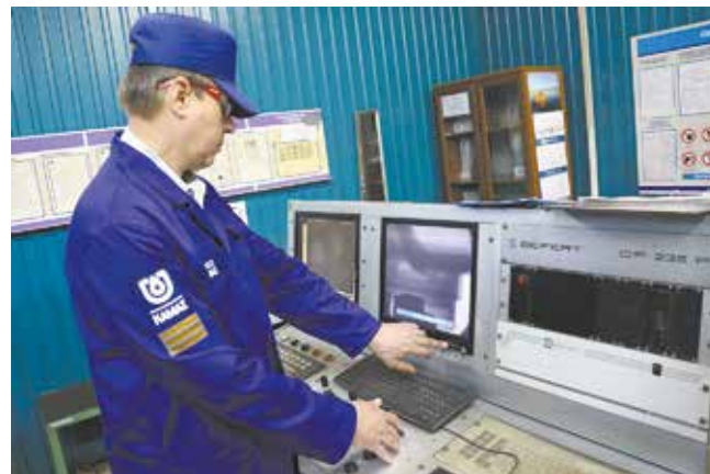
Рентген-исследования уникальны тем, что не требуют разрушений отливки
