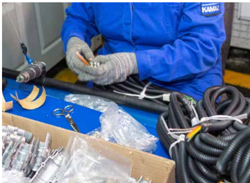
Чтобы провод жгута не застревал в гофрированной трубке, стали использовать глицерин. Дело ускорилось
