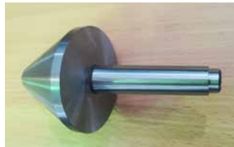
Благодаря таким конусным вставкам стало возможно проводить ручной замер биения в центрах диаметром более 20 мм
