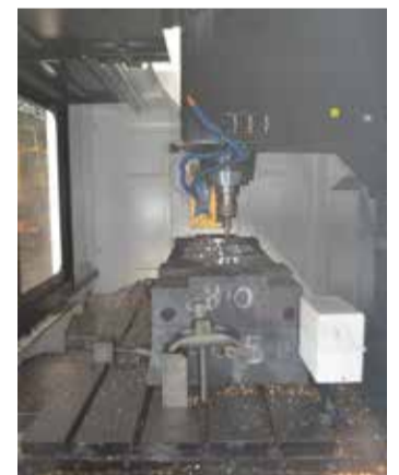
Новая стратегия обработки крупногабаритной штамповой оснастки усовершенствовала технологию её изготовления на станках с ЧПУ. Специально созданная управляющая программа и применение нового режущего инструмента позволили сократить длительность процесса в два с лишним раза
