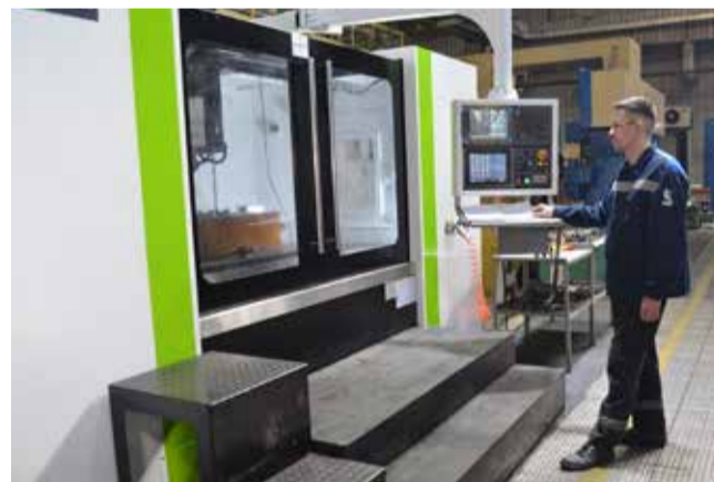
Новая стратегия обработки крупногабаритной штамповой оснастки усовершенствовала технологию её изготовления на станках с ЧПУ. Специально созданная управляющая программа и применение нового режущего инструмента позволили сократить длительность процесса в два с лишним раза
