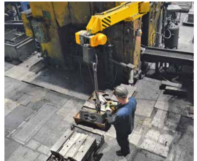
Стремясь снизить время переналадки, прямо на станине прессы LZK-4000 № 1 осуществлён монтаж консольного крана и механического манипулятора для подачи ковочных вставок. Это позволило полностью исключить потери, связанные с ожиданием работы мостового крана и погрузчика
