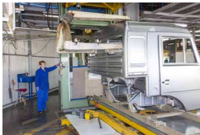
Правильно принять и посадить кабину на скид — операция ответственная
