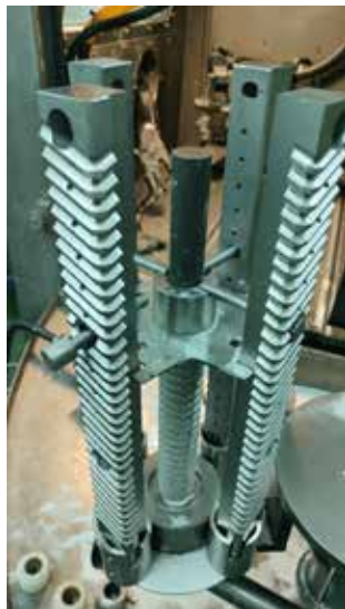
Оснастка Гильмана и Долгинова, собранная из двух пластин, винтов и нержавеющей фиксаторов, позволяет обрабатывать до четырёх протяжек одновременно
