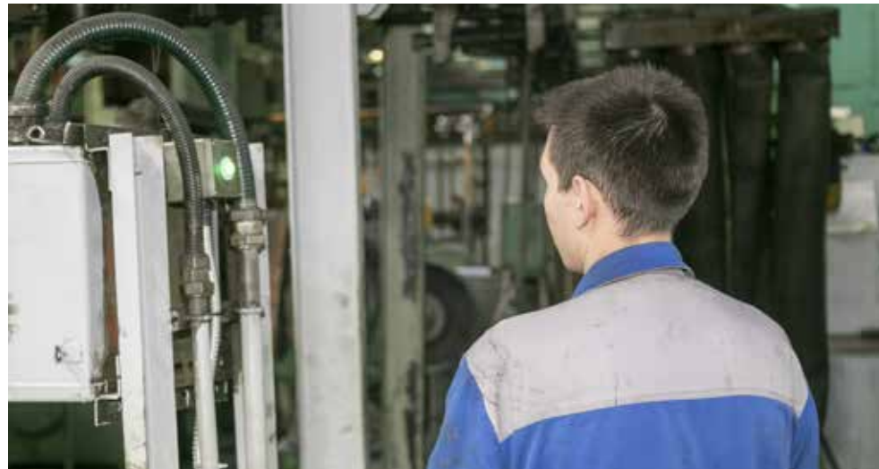
Идея мастера Исламгали Мотыгуллина — установка сигнального датчика. Если горит зелёный, подвальный конвейер работает
