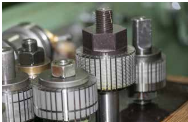
Резьбы на роликах делают твердосплавными борфрезами
