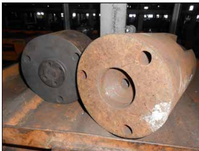
Если раньше для замены пуансона приходилось выкручивать и закручивать три винта...
