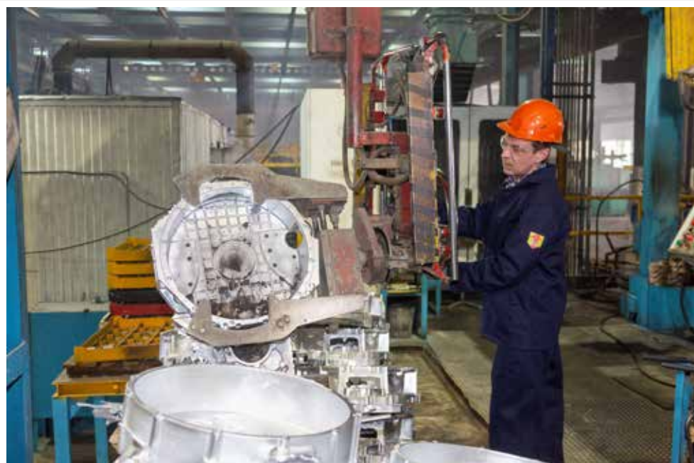
Картерные отливки увесистые, они снимаются и отправляются в тару при помощи крана-манипулятора
