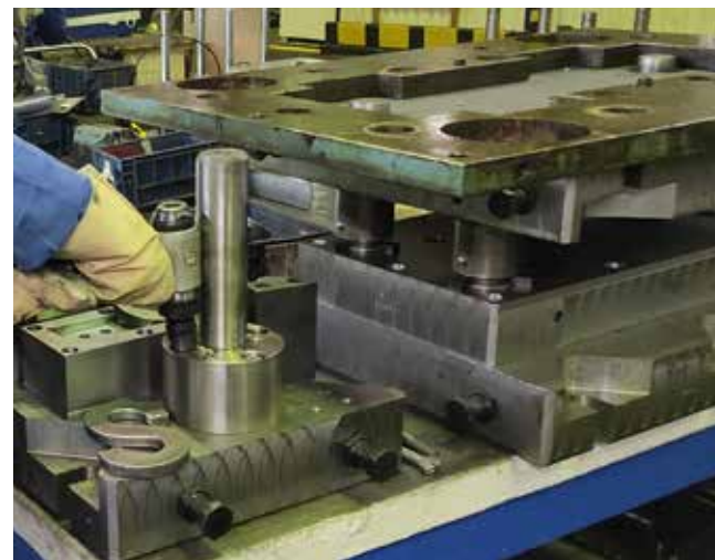
Замена штифтодёра автоматическим экономит время и силы при монтаже штамповой оснастки
