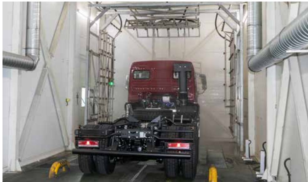
Вода льёт из всех форсунок, а в кабине сухо!
