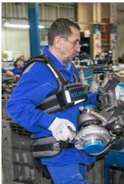
За смену приходится переносить 100 деталей по 25 кг. Экзоскелет уменьшает нагрузку втрое
