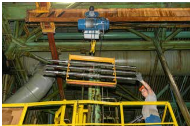
Транспортировка инструмента с новым приспособлением стала более безопасной
