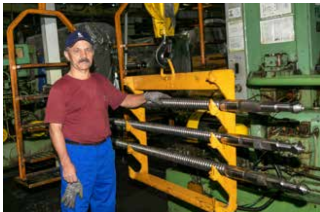
Фаиз Сафиуллин изготовил удобный захват для протяжек
