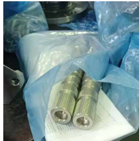
Такая транспортировка деталей АКП-2 грозила дефектами — сколами, царапинами, трещинами
