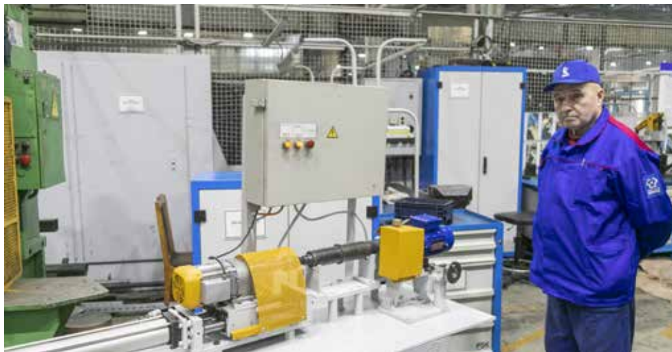
Установка позволяет очистить резьбу вала за полминуты
