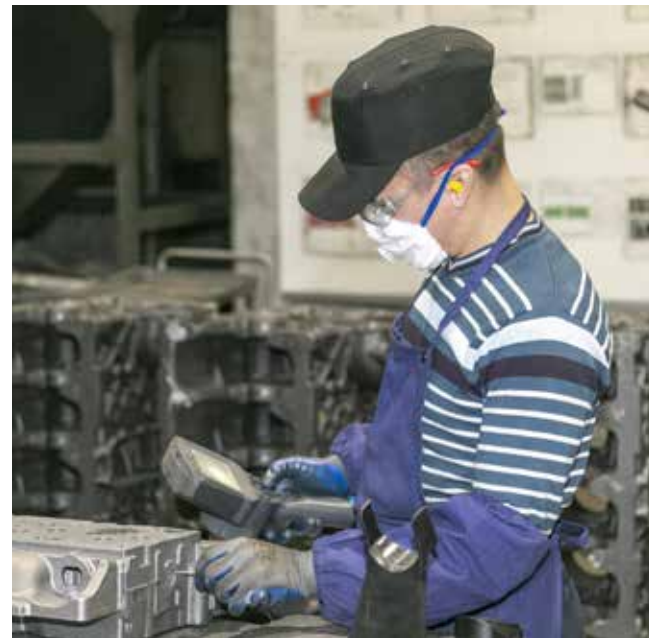
Видеоэндоскоп — верный помощник обрубщика в поиске просечек и остатков пригара внутри отливки
