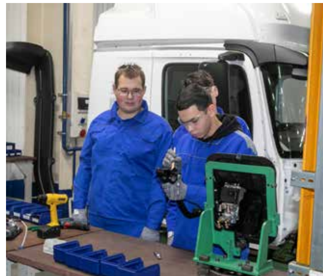
Свободный ход педали можно проверить с помощью специального щупа
