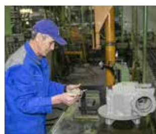
Высота и вертикальная разметка редуктора измеряется штангенрейсмасом
