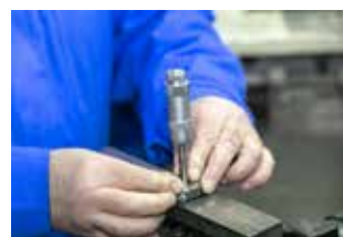
Благодаря оправке сохраняется перпендикулярность притираемой поверхности к оси «пятки» микрометра
