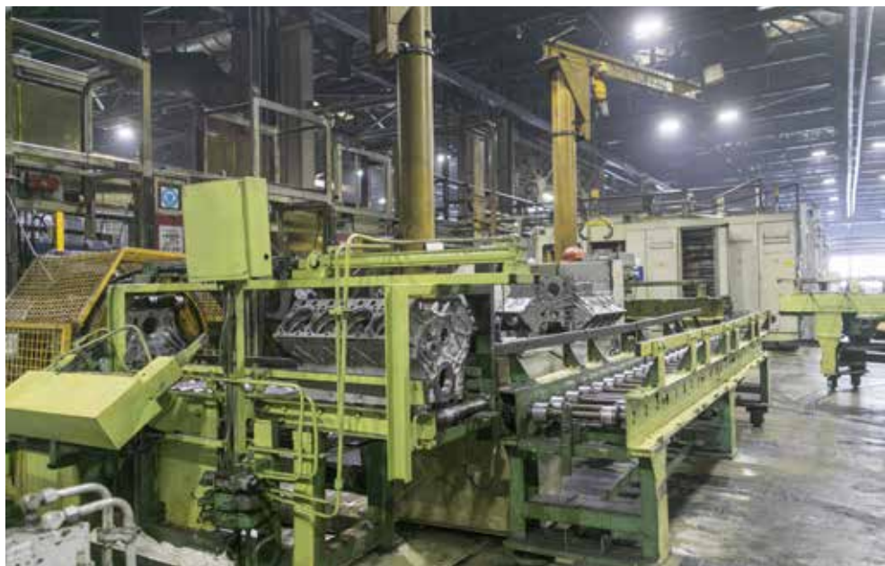
Ритмичность обработки блока цилиндра во многом зависит от функционирования транспортной системы
