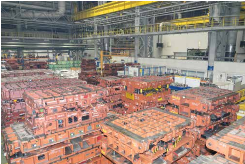
Сотни штампов в цехе штамповки и сварки деталей кабин необходимы для производства деталей для К5
