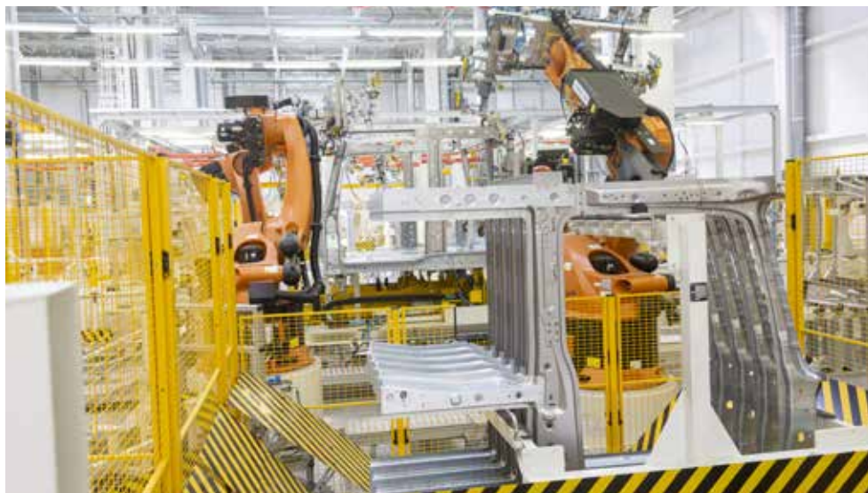
На заводе каркасов кабин самый высокий уровень автоматизации в компании — 80%
