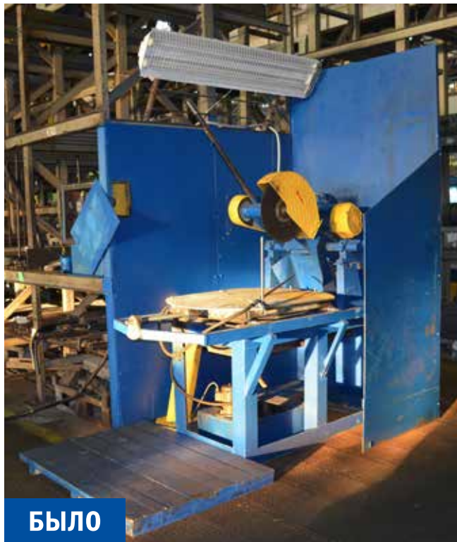
Защитный кожух на абразивно-отрезном станке не позволит искрам разлетаться
