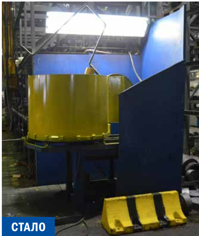
Защитный кожух на абразивно-отрезном станке не позволит искрам разлетаться
