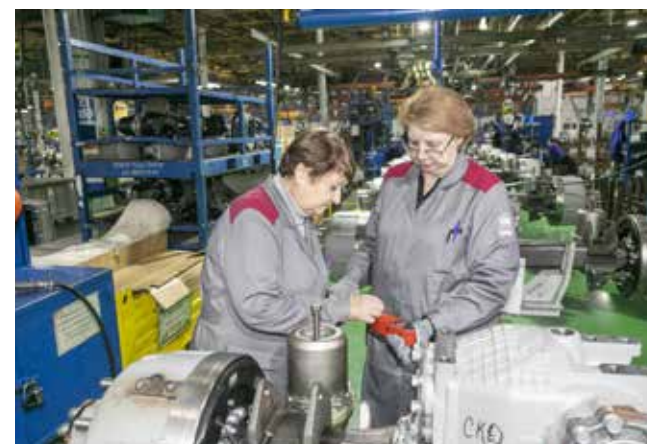
Проверка момента затяжки — важный этап
