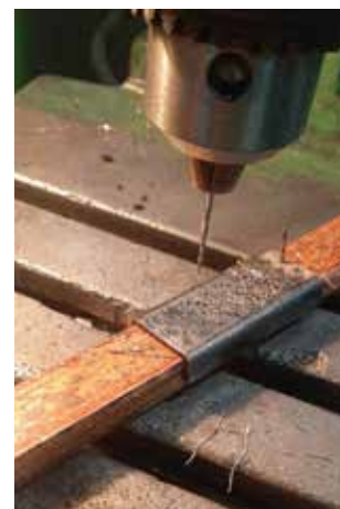
Кондуктор Раиля Курбангалиева экономит время на сверление отверстий в заготовке
