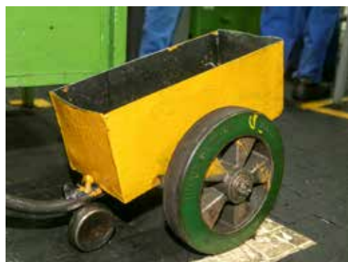
Благодаря идее Равиля приварить третье колесо к тележке стало безопаснее возить тяжёлые приводы
