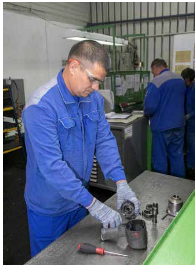
От качества сборки гайковёртов зависит момент затяжки инструмента
