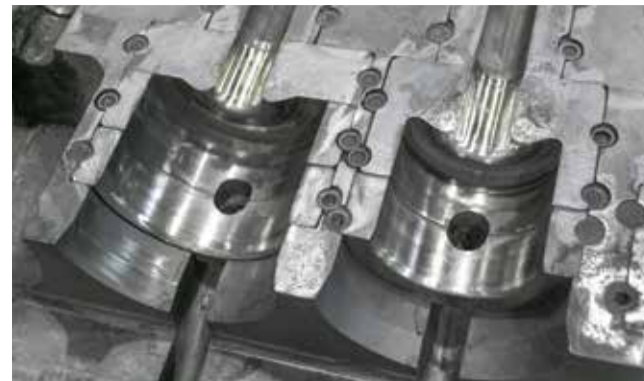
Решение разделить вставку на поковку полуоси оказалось простым и эффективным
