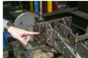
Роботу будет доверена сварка места крепления узла
