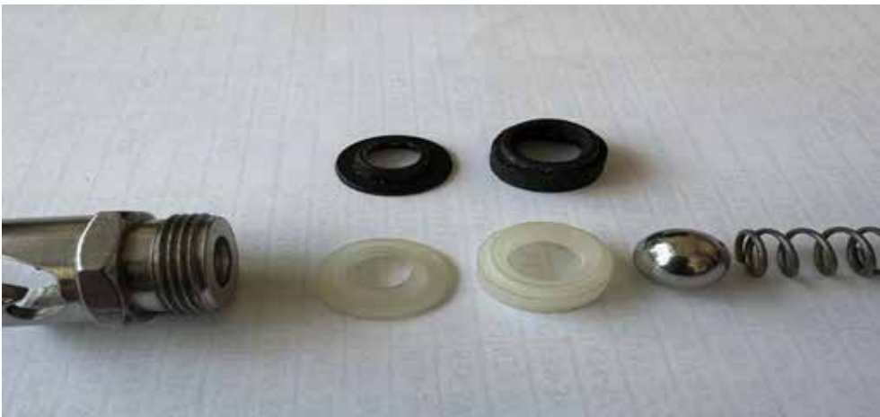
Уплотнительные прокладки из 3D-принтера сэкономили почти 200 тыс. рублей
