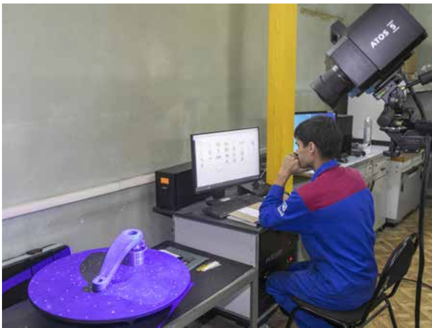
Оптическая координатно-измерительная машина оценит и геометрическую точность детали, и все размеры
