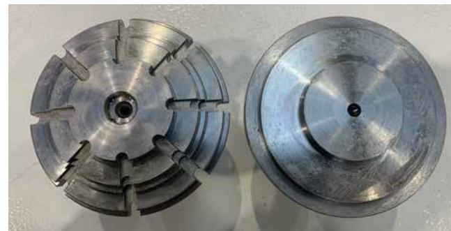
Старую оснастку (слева) сменило изобретение Руслана Хазиева. Затраты на производство фланца коробки передач значительно уменьшились
