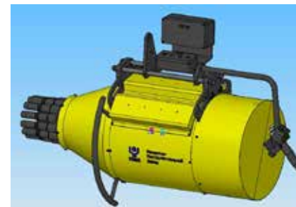
Собственная разработка рязовцев — 12-шпиндельный гайковёрт — поможет в работе на заводе мостов
