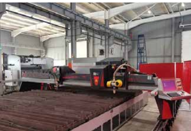
Благодаря плазменному станку детали получают без припусков
