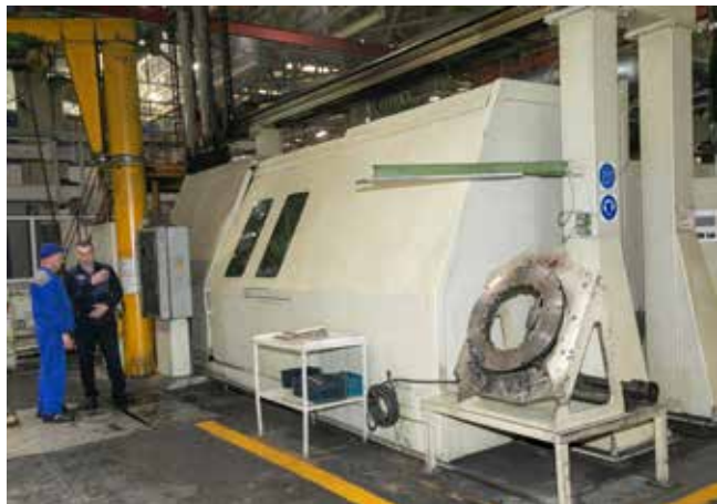
На обрабатывающем центре цеха «Коленвал и шатун» ЗД заменили винтовую пару. Изготовили эту деталь на РИЗе
