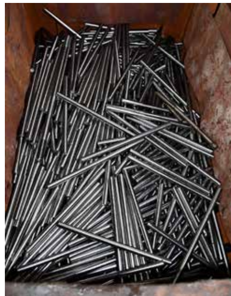
Концевые отходы теперь идут на заготовки стремянок
