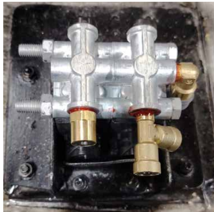
Благодаря приспособлению обеспечена качественная сборка клапана
