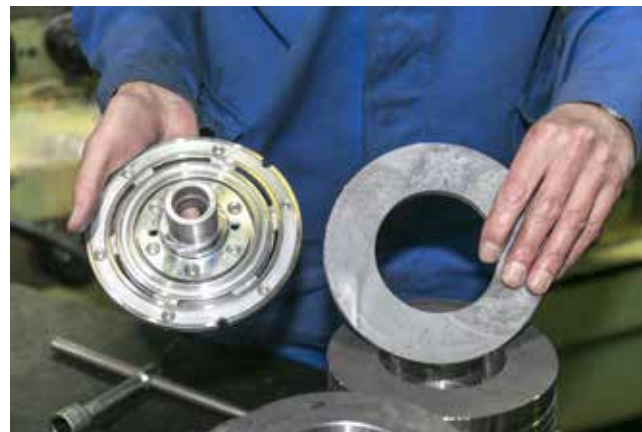
Диски для опоры вентиляторов получаются из такой заготовки
