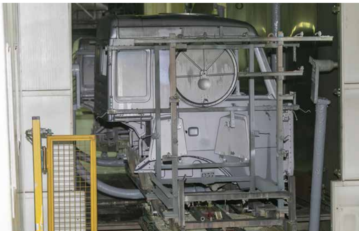
По этому конвейеру каркас кабины отправляется в агрегат подготовки поверхности
