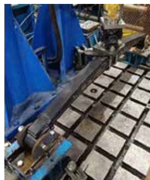
С помощью модернизированного электрогидравлического испытательного комплекса Inova теперь можно проводить статические и циклические испытания рессор
