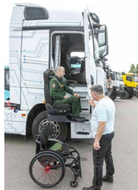
Кресло оснащено гидравлическим подъёмным механизмом, что позволяет делать посадку непосредственно с земли
