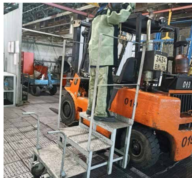
Подкатная тележка позволяет выполнять сварочные работы на высоте
