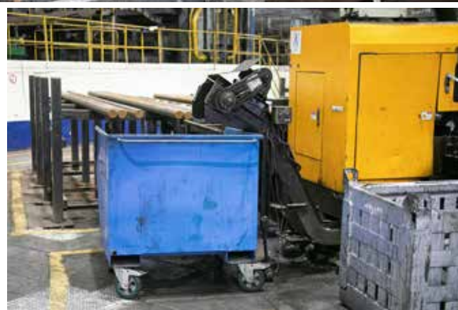
Стружкоаккумуляторы удобнее, чем тары, и экономят время операторов
