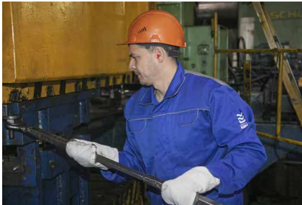
Наладить пресс нужно таким образом, чтобы на заготовках не было ни царапин, ни заусенцев
