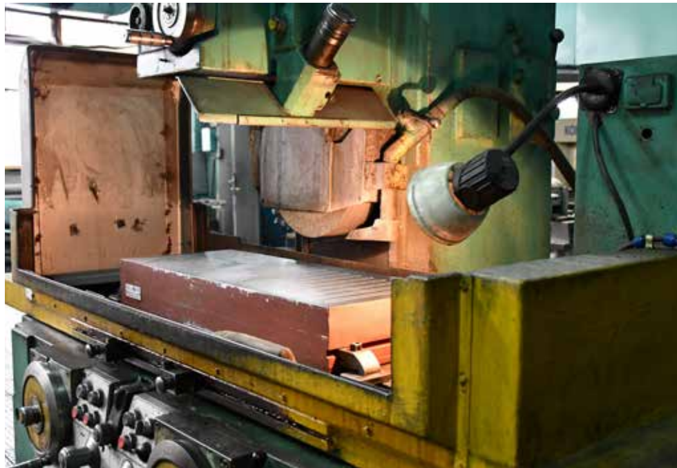
Высокий кожух (слева) не даёт разлетаться абразивной пыли
