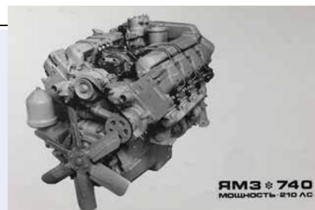
Первый камазовский двигатель был 210-сильным...
