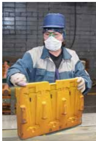
Перед заливкой важно тщательно обработать поверхность формы
