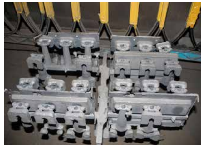
Благодаря новой технологии литейщики могут получить в 2,4 раза больше валов привода ТНВД
