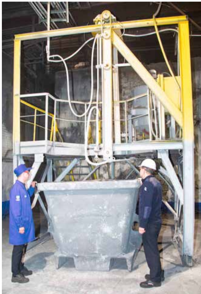
Побелочная машина ускорила и упростила покраску шлаковень в литейном цехе № 1
