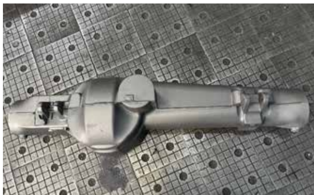
Цельнолитый картер моста получился легче и прочнее, чем сварной
