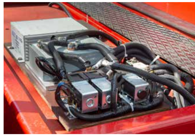
Современный блок управления расходует на треть меньше заряда АКБ
