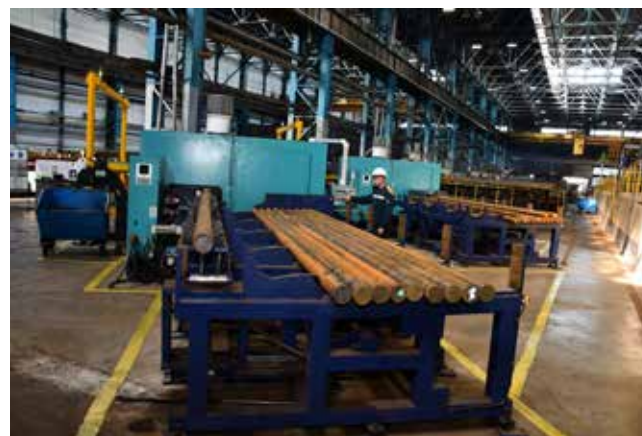
Подача металлопроката в зону распила идёт автоматически
