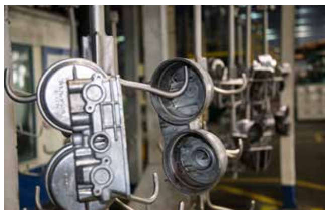
На крюках отливки держались некрепко и часто оставались на полу дробемётной установки
