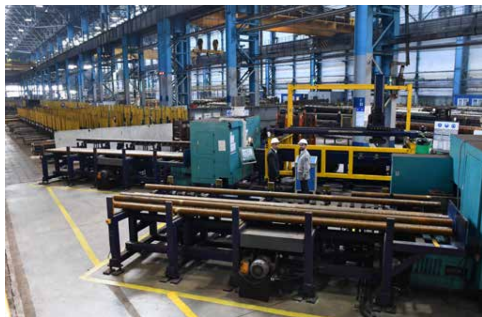
Рабочая производительность одной линии F-200NC составляет 8,5 тонны в час заготовок
